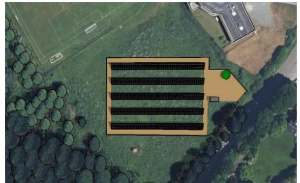
La mise en œuvre de ce parc solaire photovoltaïque au sol prévoit une puissance totale de 250,0 kWc (500 modules de 500 Wc ou équivalent), sur une emprise au sol d'environ 3 700 m<sup>2</sup>. La commune deviendra producteur et revendeur d'électricité.
